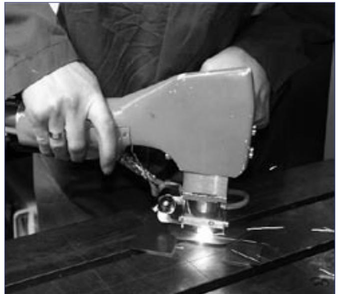
Für einen praxistgerechten Einsatz wurde ein ergonomisch ausgestaltetes Gehäuse angefertigt, das die optischen Komponenten und die Elektronik mit Sicherheitsschaltung enthielt. Durch das Zusammenführen der Versorgungsanschlüsse im Griffstück wurde das Kabelpaket kompakt herausgeführt und war dadurch besser zu handhaben.
